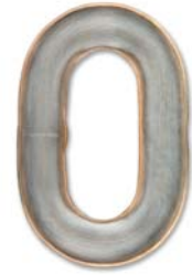
Längsschliff eines Kettengliedes in der Qualität KU 350E14 (Aufkohlungstiefe E14=0,14 \times d ) longitudinal grinding of a chain link of quality type KU 350E14 (carburizing depth E14 = 0.14 \times d )
