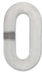
Längsschliff eines ungehärteten Kettengliedes longitudinal grinding of an unhardened chain link
