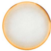
Querschliff eines Kettengliedes in der Qualität KU 400E9 (Aufkohlungstiefe E9=0,09 \times d ) transverse section of a chain link of quality type KU 400E9 (carburizing depth E9 = 0.09 \times d )
